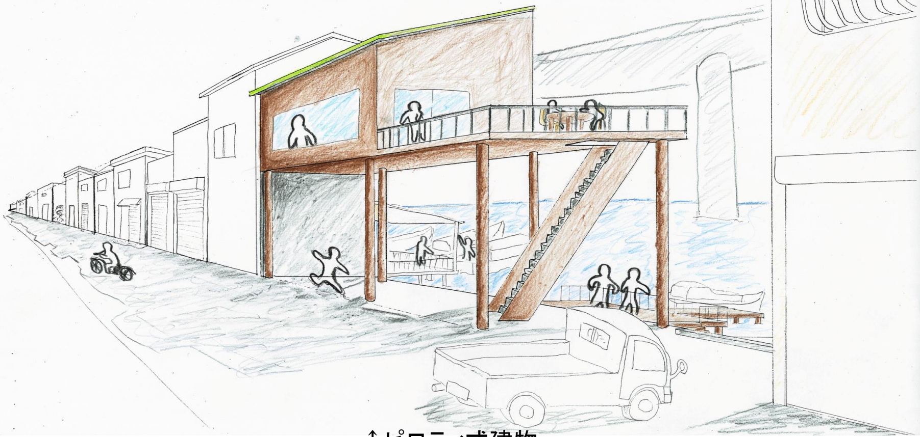
↑ピロティ式建物
