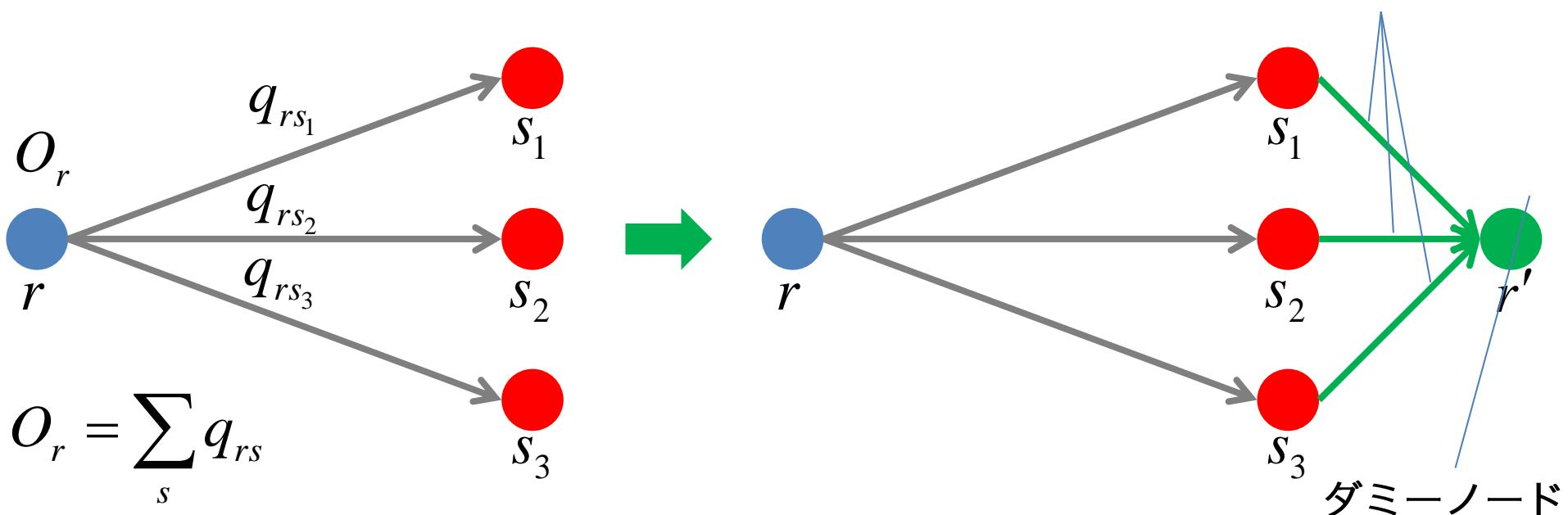
$$\begin{aligned} \text{各ダミーリンクの旅行時間 } r - s_1 &\rightarrow -Ms_1 \\ r - s_2 &\rightarrow -Ms_2 \\ r - s_3 &\rightarrow -Ms_3 \end{aligned}$$
